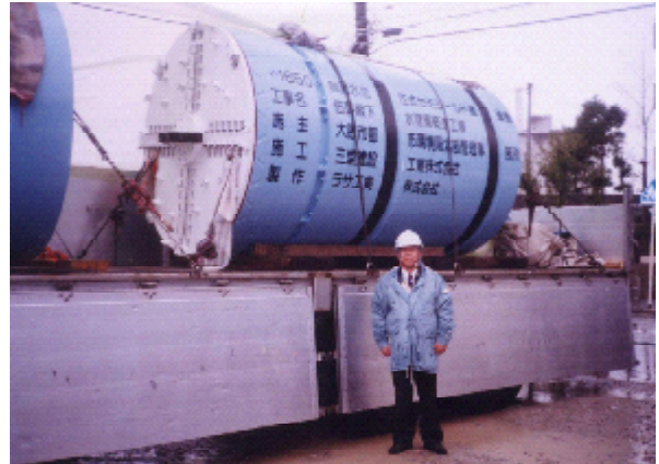
写真 - 3 泥水掘進機(DH-K)
